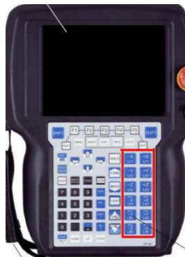
7. ábra Teach Pendant való kézi mozgatáshoz szükséges gombok (FANUV_Robot_KAR szerkesztve)
