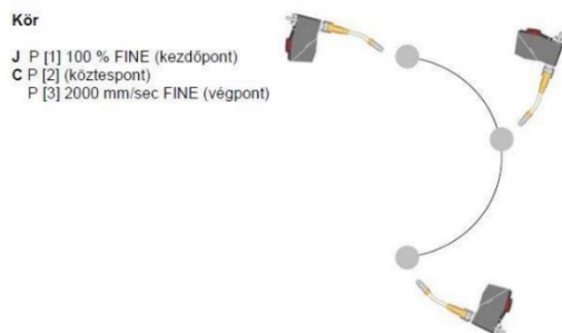
11. ábra Circular mozgás. Fanuc_Robot_KAH szerkesztve
