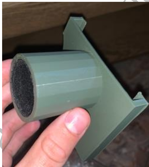
10. ábra: Az okostelefon kamerájára rárakható 3D nyomtatott eszköz
