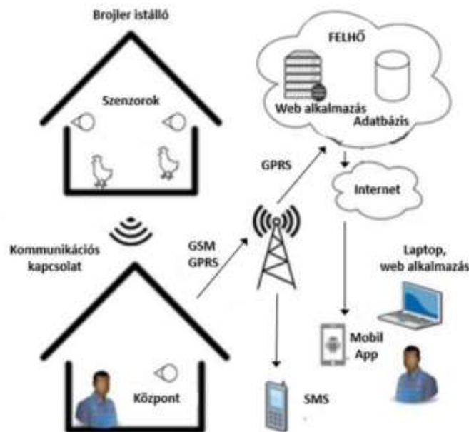
7. ábra Monitoring rendszer működési vázlatja (SZTE)
