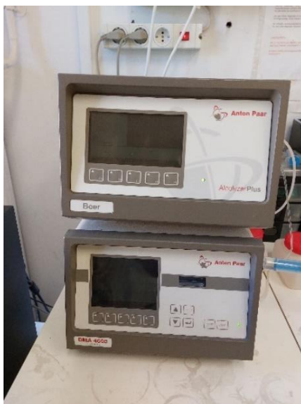
14. ábra: Alcolyzer Plus készülék
