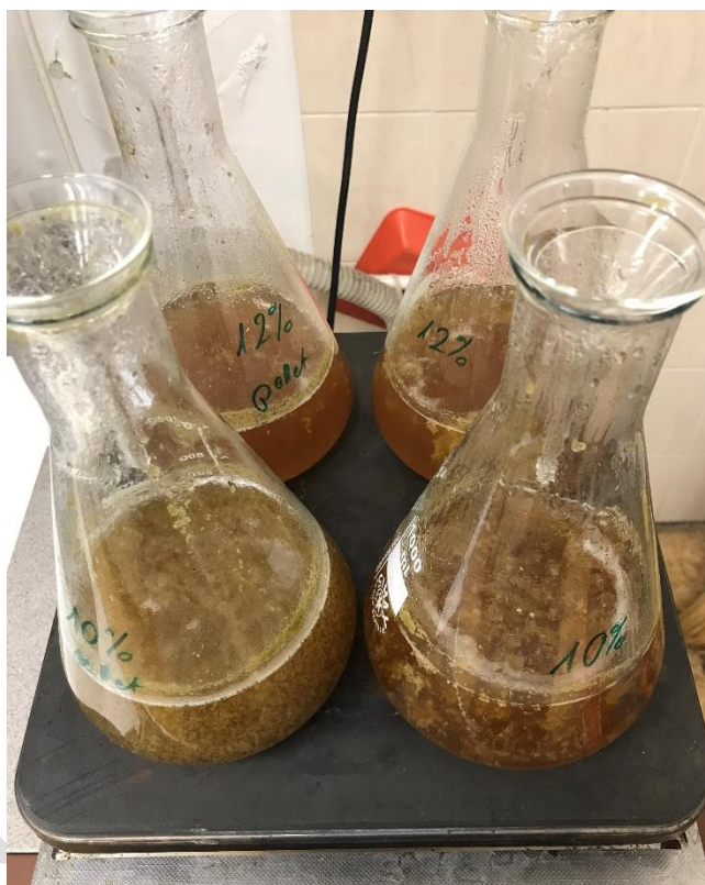
7. ábra: Sörlevek forralása, a komlókészítmények hozzáadását követően
