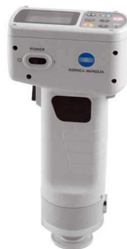
6. ábra: Minolta CR-400 színmérő berendezés (internet 6)
