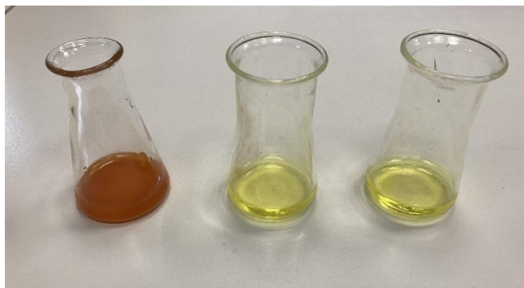
19. ábra: A színátcsapás szemléltetése: citrom színről narancsos színre változott oldat jelezte a reakció végbemenetelét a sótartalom meghatározásnál.
