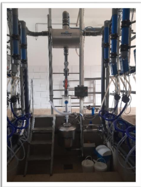
12. ábra A fejőrendszer fejőgépe (Farkas 2023)
