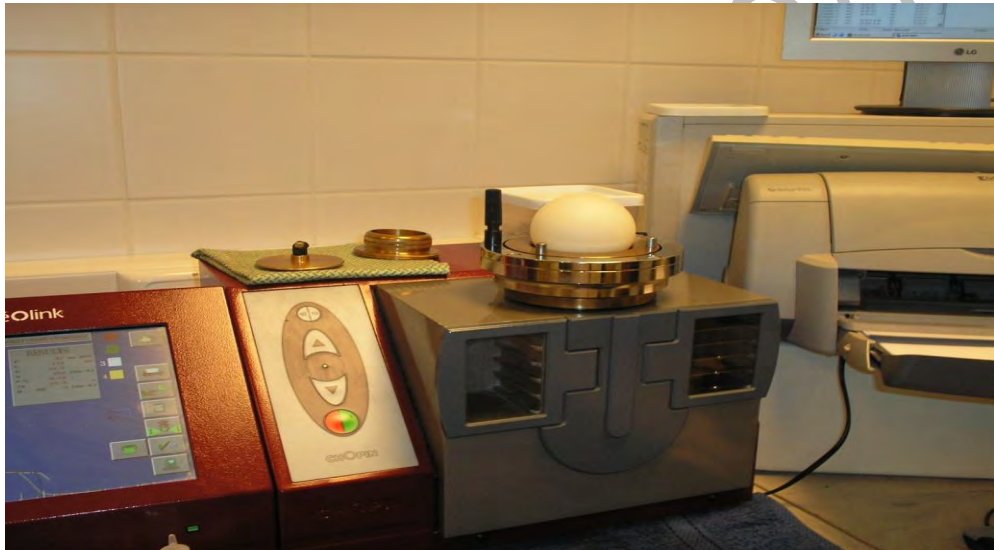
1.kép: Alveográf működés közben
