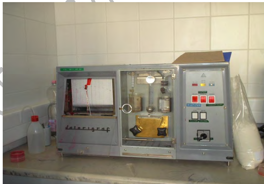
2.kép: Valorigráf működés közben
