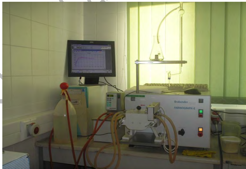
3.kép: Farinográf működés közben
