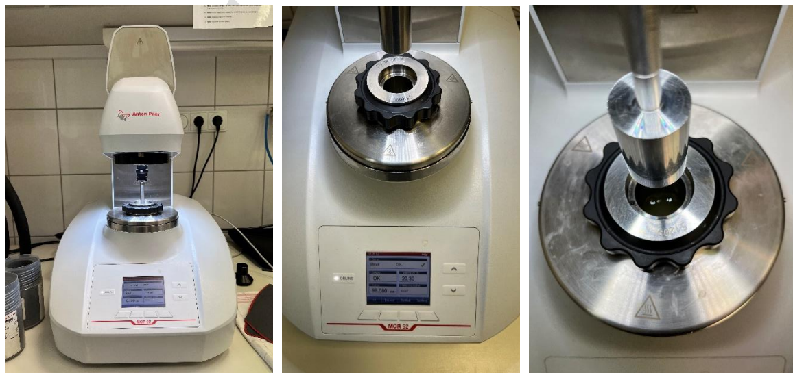
15.ábra: A tojásfehérjelé viszkozitásának mérése Anton Paar MCR 92 berendezéssel
