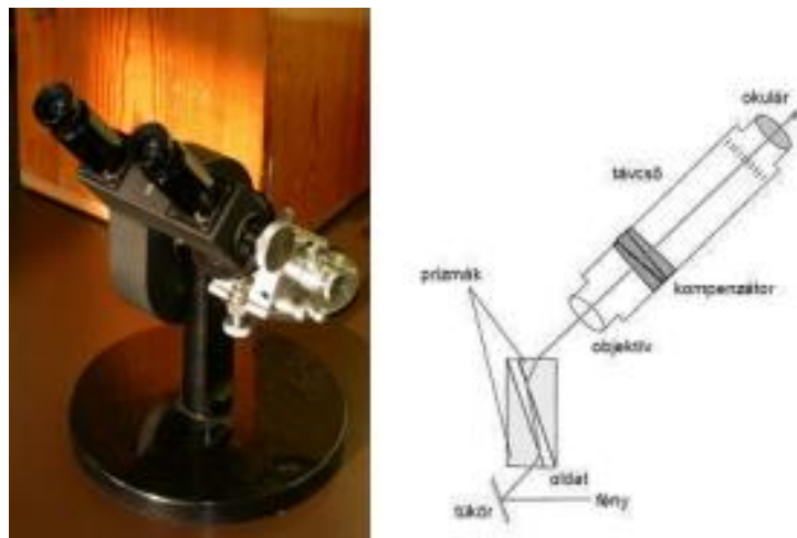
10. ábra Zeiss Abbé- féle refraktométer (balra), a műszer felépítése (jobbra) (Szegedi Tudományegyetem- 5.pdf)
