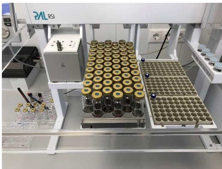
8. ábra : Heracles Neo készülék mintatartó része, benne a mintákat tartalmazó vialokkal (forrás: saját fotó)
