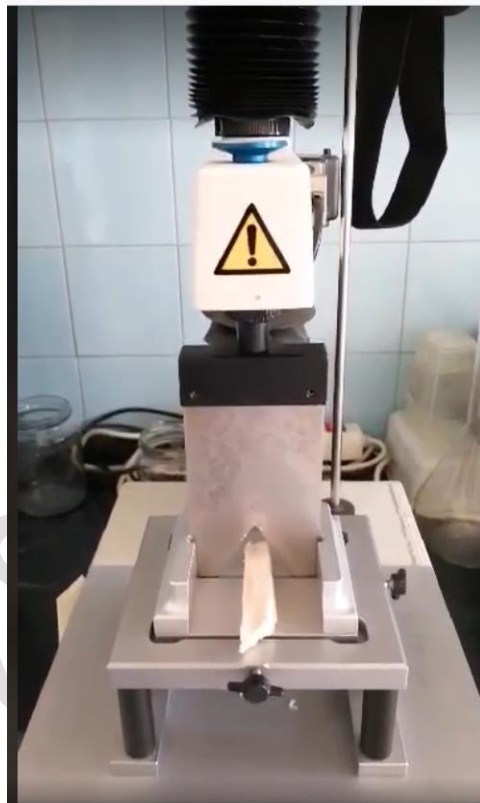
9. ábra: Porhanyósság vizsgálata TA XT Plus nyíróerő-érték mérő műszerrel (saját fotó)*
