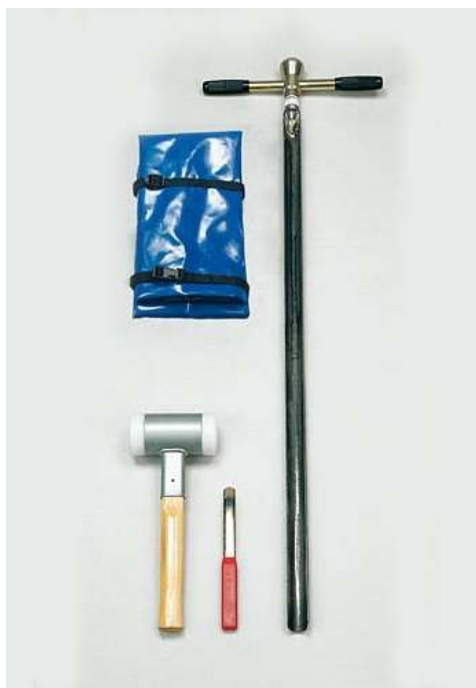
9. ábra: 1m-es fúró készlet kemény talajhoz (Forrás: internet)
