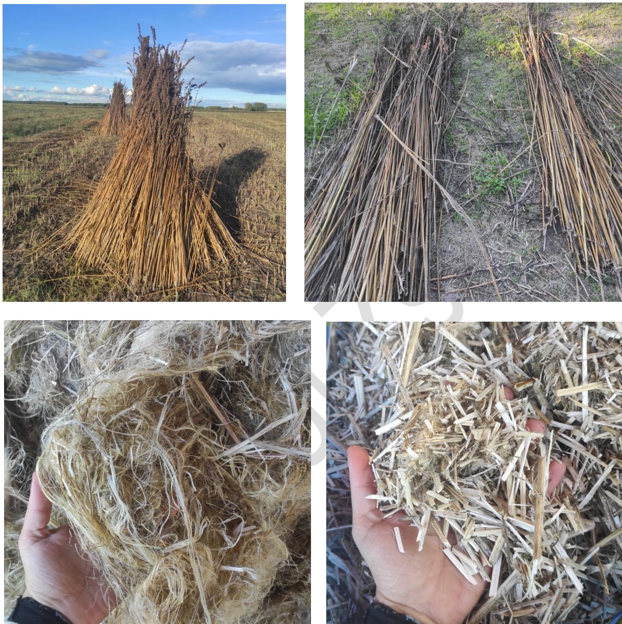
15. ábra. A felső sorban balról jobbra a kúpba, illetve a halomba rakott kísérleti növények, az alsóban szintén balról jobbra a dekortikálás során szétválasztott rost, illetve pozdorja látható. (Saját felvétel 2022. szeptemberén)
