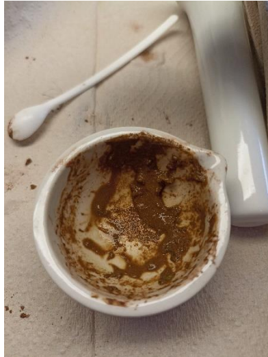
14. ábra: Az összevegyített minta és homok
