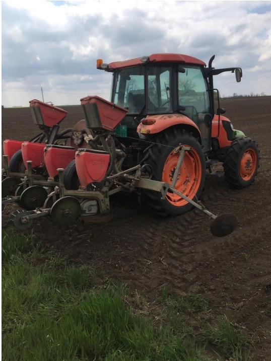
2-3. ábra: A vetést egy Nodet pneumatikus négy soros vetőgéppel, a gruberozást pedig egy Lemken merevkapás 2,8 méteres kapcsolható eszközzel végeztük (Fotó: Gulyás Réka)
