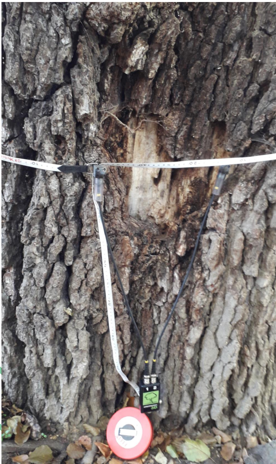
V. – 16. ábra: Az 1-es és 2-es PIEZO érzékelők felrögzítve az R01 enyves égerfa törzsén, a kéreg és hánccsérülés közelében a műszeres favizsgálat elején (2022. október 25.)
