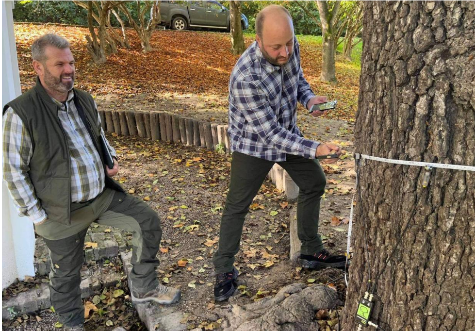
V. – 17. ábra: A 3-as PIEZO érzékelő megütése hangsebesség méréshez az R01 enyves égerfa törzsén (Puskás, 2022. október 25.)
