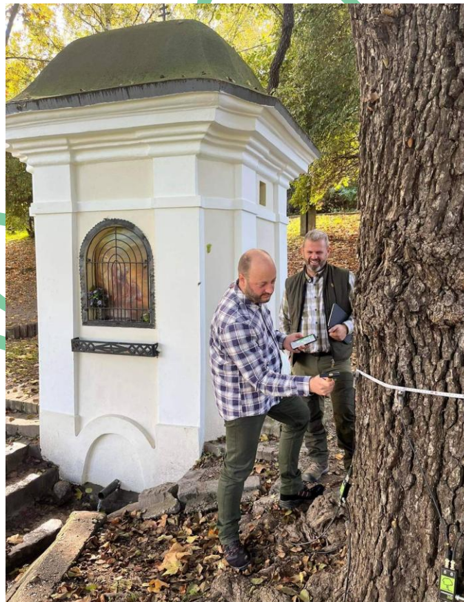
V. – 18. ábra: A 4-es PIEZO érzékelő megütése hangsebesség méréshez az R01 enyves égerfa törzsén (Puskás, 2022. október 25.)
