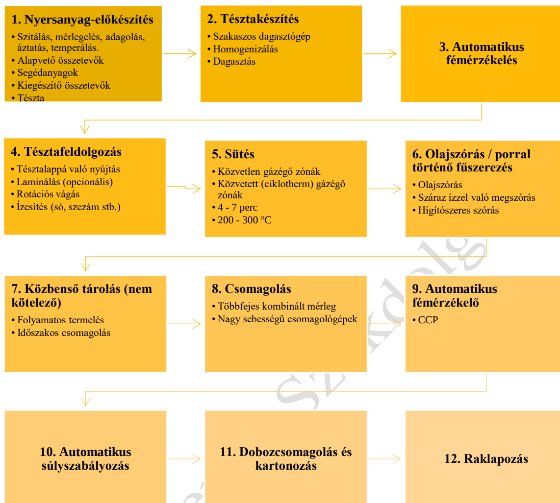
7. ábra: Laminált vágott kréker gyártási folyamat
