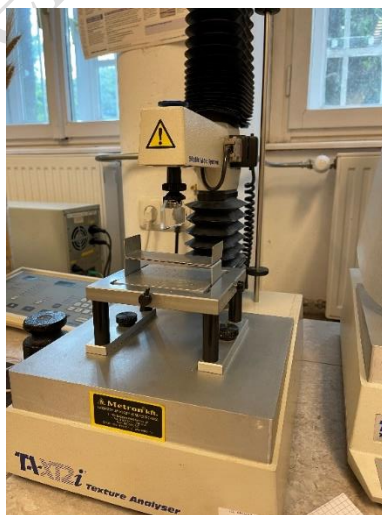
8. ábra: Stable Micro System TA-XT 2i állománymérő készülék (saját fotó, 2021. május 13.)
