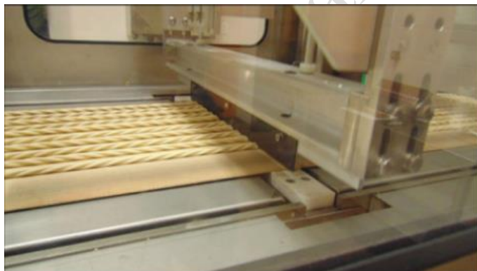
5. ábra: Extrudálás - Guillotine vágóval vágott fonott „kötél” (Ken Zvoncheck, 2021.)
