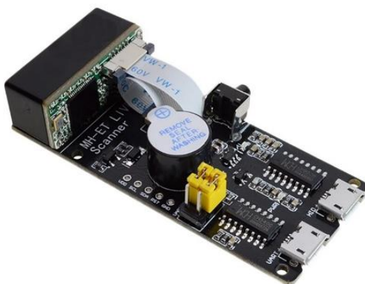
8. ábra: MH-ET LIVE Scanner 3.0 vonalkód olvasó modul (Internet 15)
