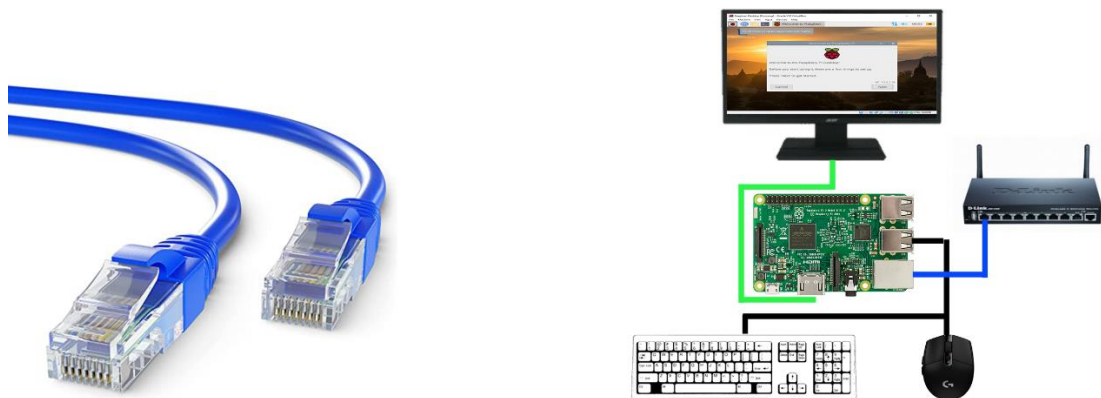
13. ábra: Ethernet kábel (bal), és Ethernet internetösszeköttetés Raspberry készülékkel (jobb) (Internet 16-19, Internet 23-24)
