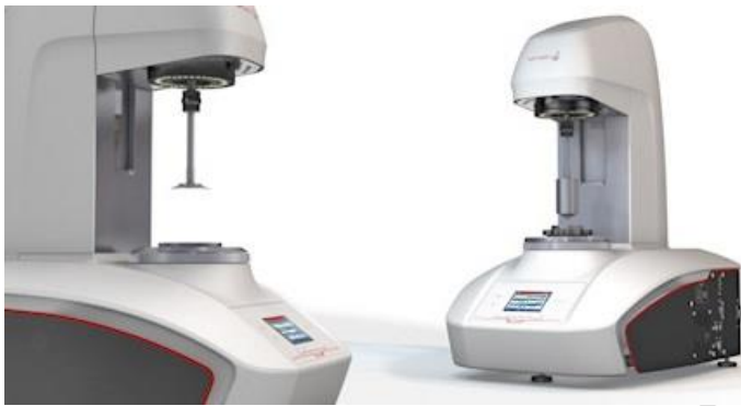
12. Ábra: Rotációs és oszcillációs viszkoziméter (MCR 92 Physica, Anton Paar)
