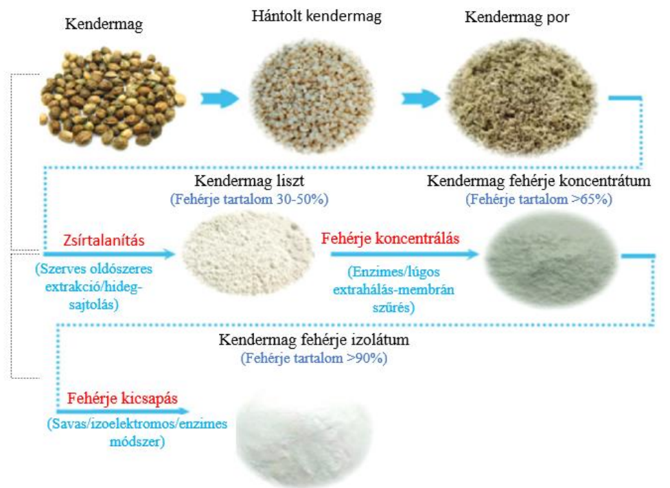
4. Ábra: Áttekintés a kendermag fehérje extrakciós lépéseinek folyamatáról (általános módszer) (Forrás: H.H Chen et al., 2023)
