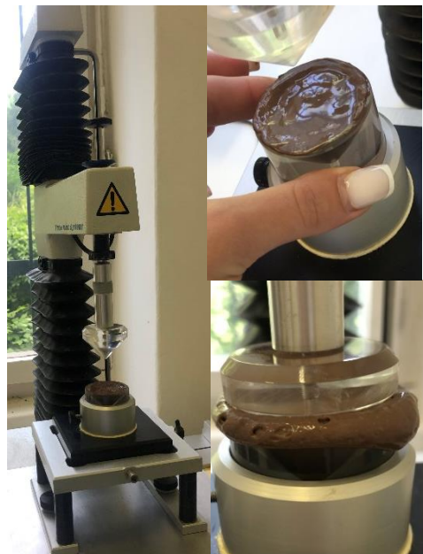
8. Ábra: Állománymérő műszer, illetve küvetta (TA.XTplusC Texture Analyser)
