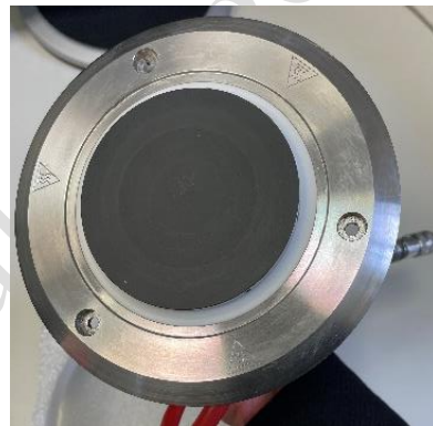
13. Ábra: Lap-lap mérőrendszer, alsó eleme (PP50)
