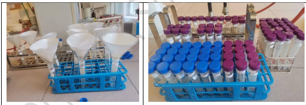
10. ábra: A minták szűrése üvegtölcsérral és szűrőpapírral, illetve az így kinyert minták
