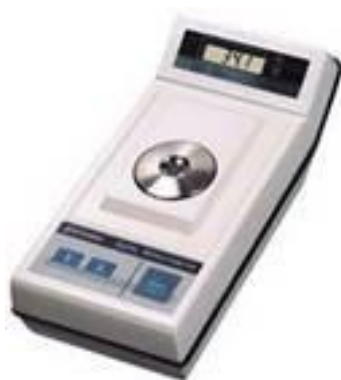
5. ábra: Atago DBX-55 digitális refraktométer (Internet 6)
