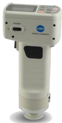
7. ábra: Konica Minolta Chroma Meter CR-400 felületi színmérő (Internet 7)
