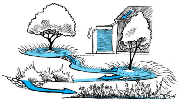
75. ábra: Kialakítási javaslat kombinált rendszerhez (forrás: http4 )
