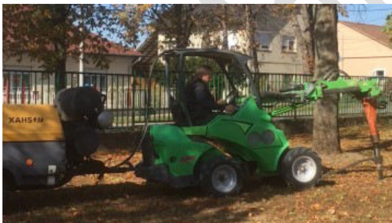
6. ábra: Talajszellőztetés végzése géppel – nagynyomású levegővel (Internet 6)
