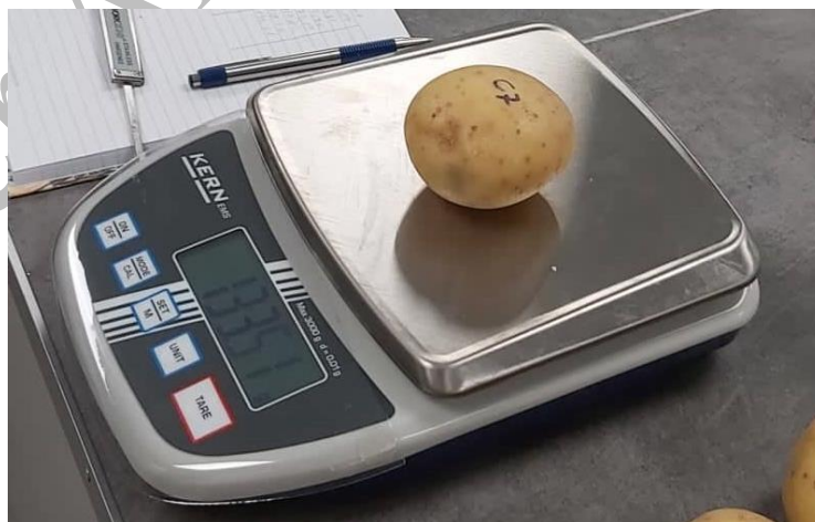
4.ábra A tömegmérésekre használt KERN EMS 12K0.1 típusú labormérleg (saját fotó, 2022)
