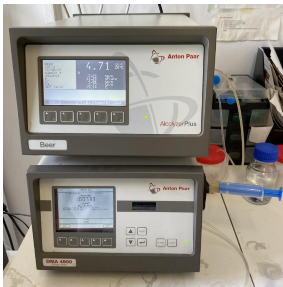
7. ábra: Anton Paar AlcoLyzer Plus söranalizátor (Forrás: saját kép)
