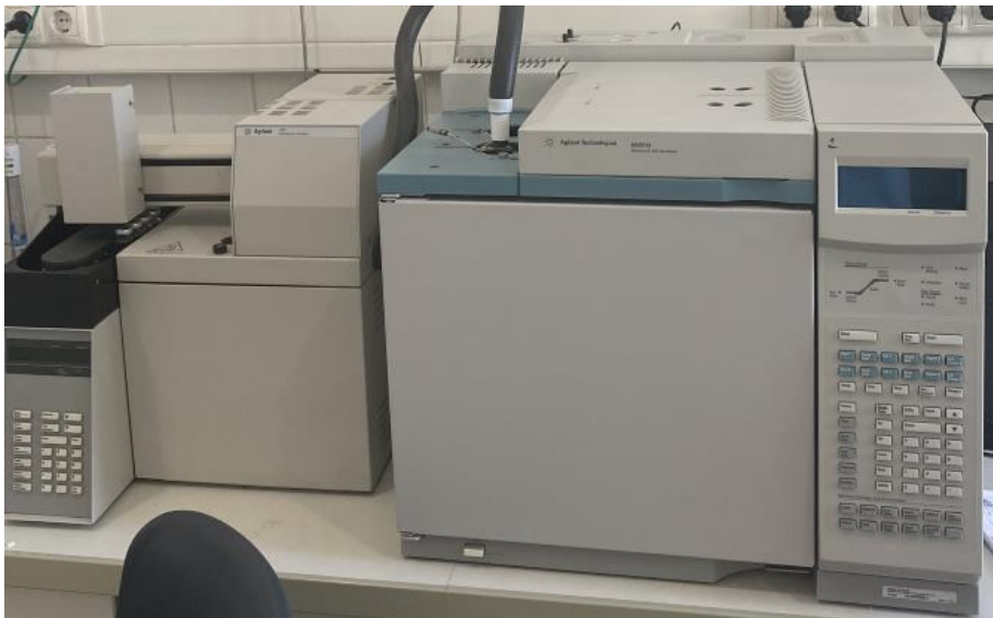
10. ábra: Agilent 6890N Gázkromatográf és HS 7694 headspace sampler (Forrás: saját kép)
