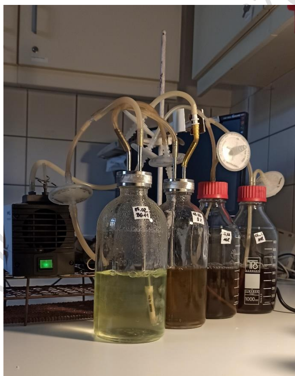
2. ábra: Mikroalga tenyésztése levegőztetett fotobioreaktorban (BG11 tápoldatban és hígított növényi présleiben)
