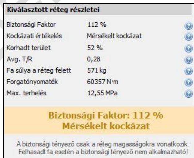
11. ábra: Vadgesztenye (AH3) vizsgálati rétegéhez (20 cm rétegmagasságon 12 érzékelővel végzett mérés) számított biztonsági tényező
