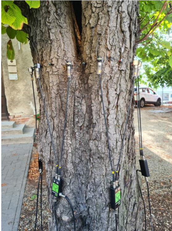
23. ábra: 12 db Ludwig-szög kiosztása 12 db Piezo érzékelő közé
