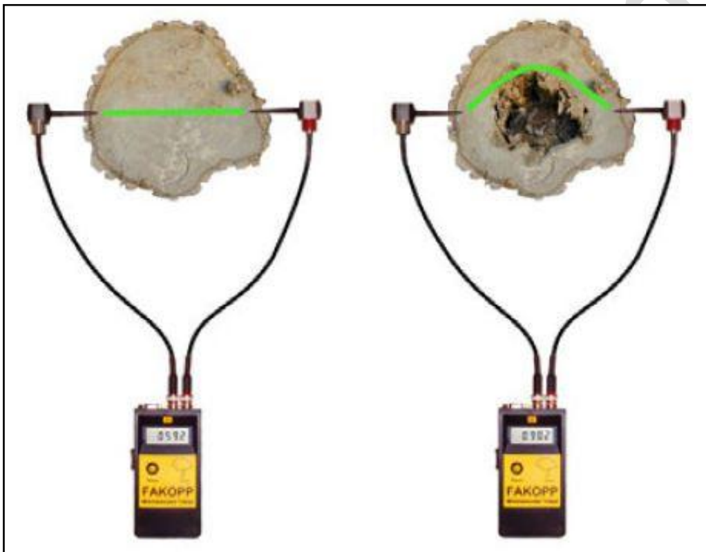
4. ábra: Példa egy 1D-s, vonalmenti akusztikus mérésre (forrás: BUZA, 2021)
