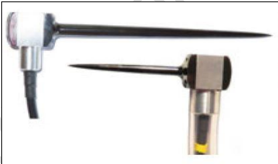
6. ábra: A Fakopp 3D Akusztikus Tomográfhoz tartozó 6 cm-es és 12 cm-es („normál”- és „hosszútüske”) Piezo érzékelők
