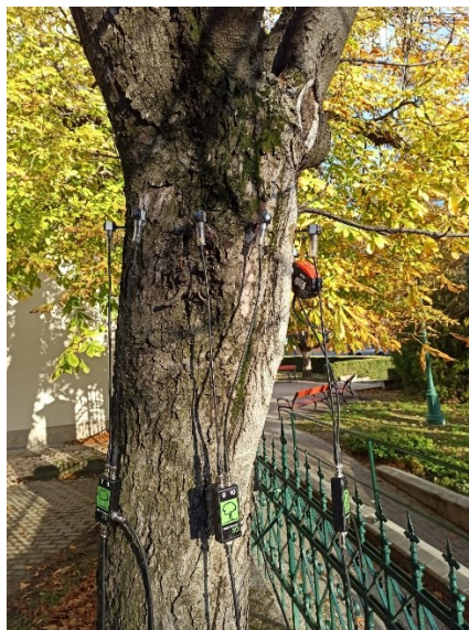
17. ábra 26 os vadgesztenye műszeres vizsgálata
