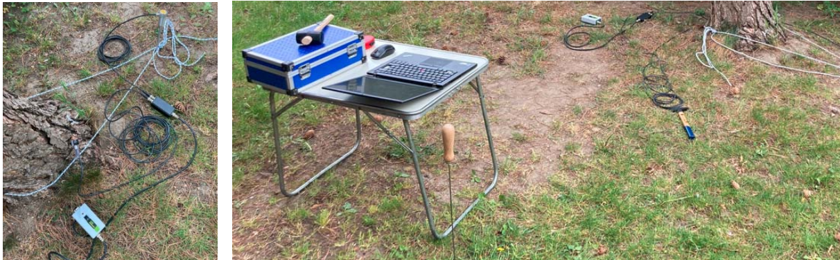
6. ábra: A jeladó és érzékelő elhelyezése (forrás: saját fotók)
