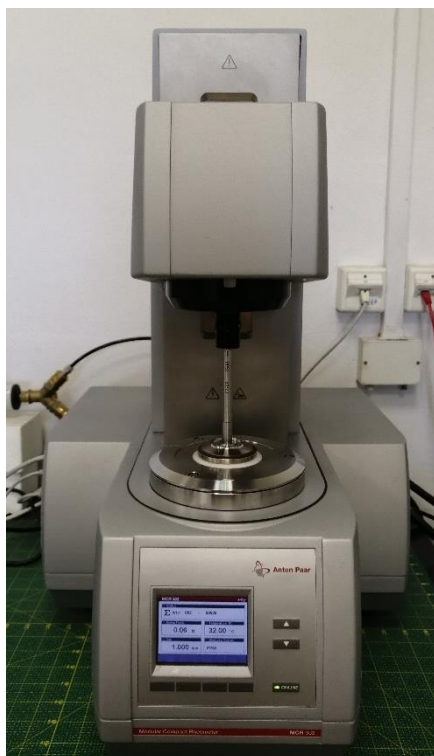
5. ábra: Anton Paar MCR302 reométer
