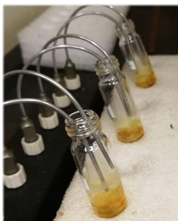
8. Ábra - Evaporálás nitrogén gázzal
