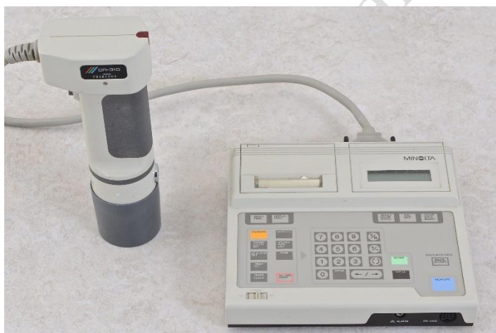
6.ábra: Konica MINOLTA CR-310 kézi színmérő berendezés (forrás: Internet 5)
