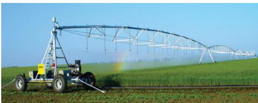
4. ábra: Lineár öntözőberendezés (Forrás: http4)
