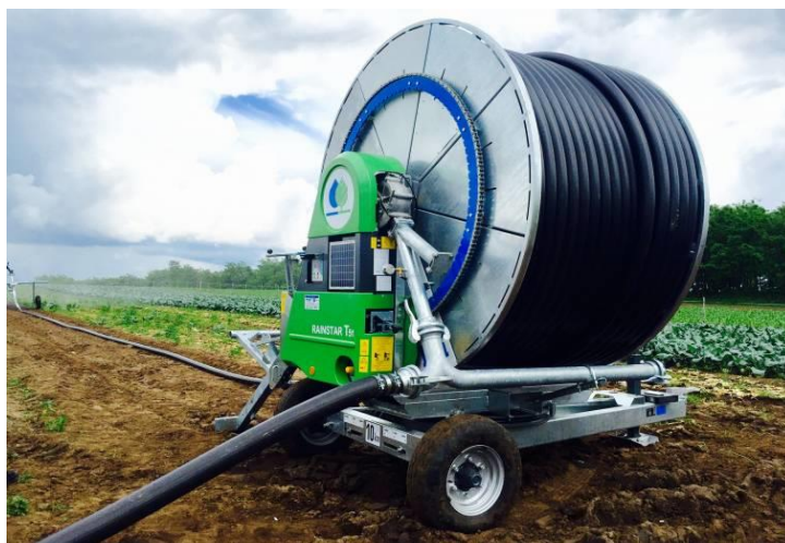
3. ábra: Csévéldobos öntözőberendezés (Forrás: http3)
