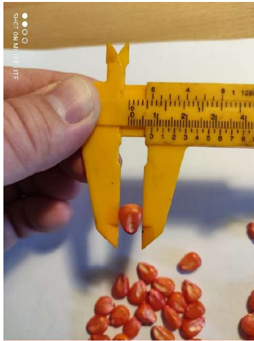
8.ábra Vetőmag méretezés: szélesség 8 mm
