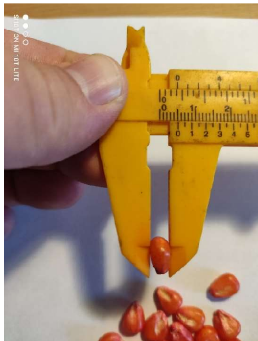
7.ábra Vetőmag méretezés: vastagság 5 mm
