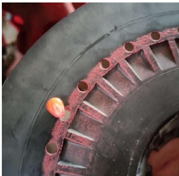
11.ábra A Vaderstad Tempo nyomottlevegős vetőgép magadagoló tárcsája
