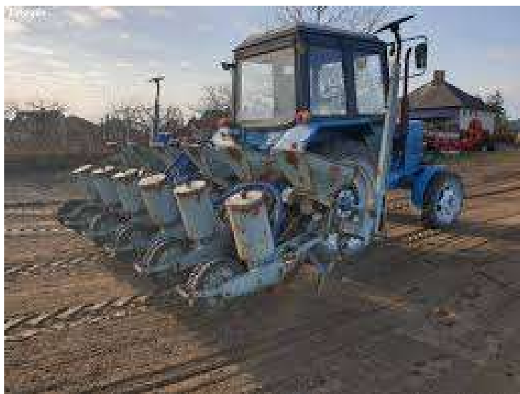
5.ábra Pneumatikus, szívottlevegős vetőgépek egy jeles képviselője az SPC 6
