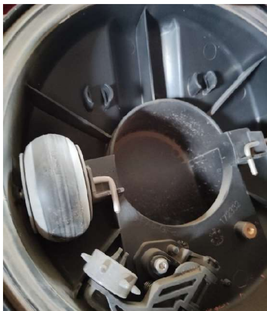
12.ábra A nyomást megszüntető gumikerék és a vetőtárcsa tisztító kereke (Vaderstad Tempo)
