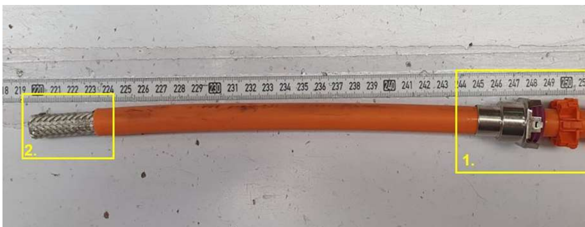
21. ábra Behelyezett alkatrész és a kábeltől eltávolított külső köpeny (forrás: Lear.com )
