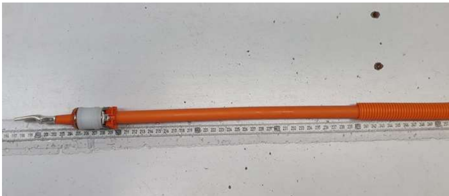
23. ábra. Az "A" oldal elkészült és a cső behelyezve (forrás: Lear.com )
