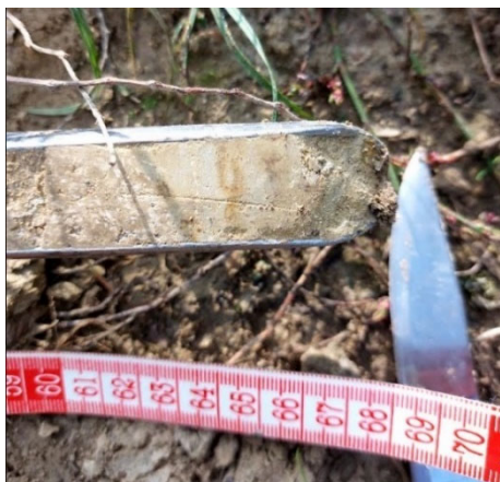
8. ábra: Vaskiválás az alapkőzetben a korosbító talajmintánál
