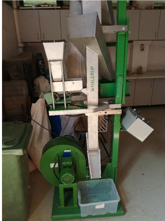
5. ábra. HAIDRUP DC 20 magtisztító és válogató gép (Forrás: Saját fotó)
