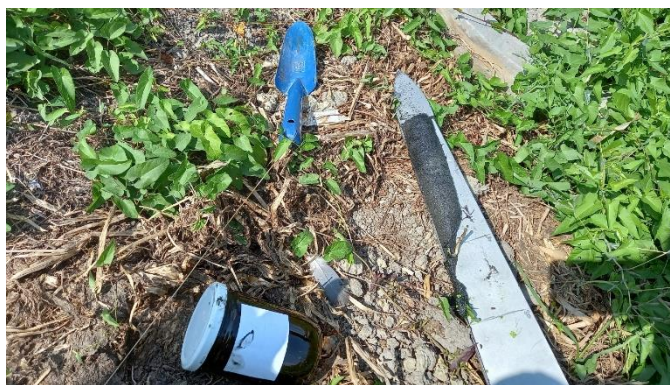
8. kép Mintavétel "Peat" mintavevő eszközzel 2022.08.15-én, 9034 Tápiószéle, Hajta alatt (saját kép)
