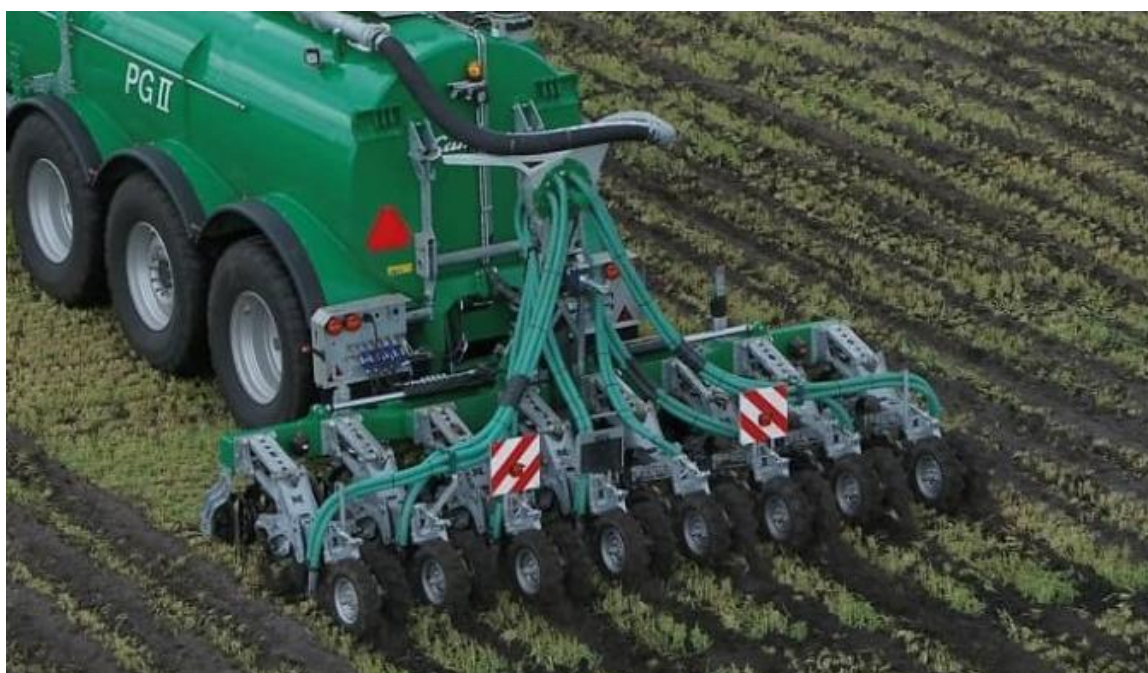
2.kép: Szennyvíziszap injektáló berendezés 2
