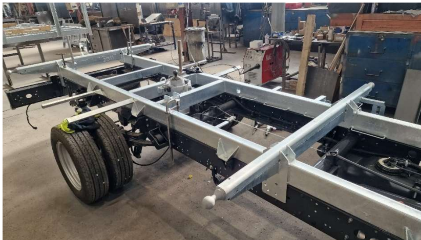
23. ábra: Járműre felhelyezett segédváz
