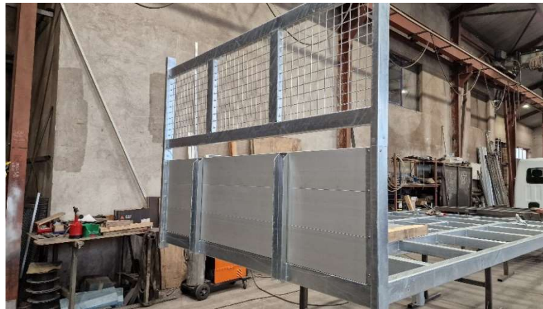
26. ábra: Összehegesztett felépítmény váz
