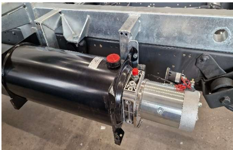
24. ábra Rögzített bekötésre váró hidraulikus motor
