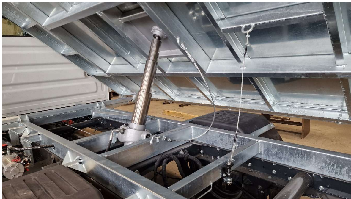
30. ábra: Billenő létra (bal oldalt), hidraulikus munkahenger (középen), drótkötelek (jobb oldalt)
