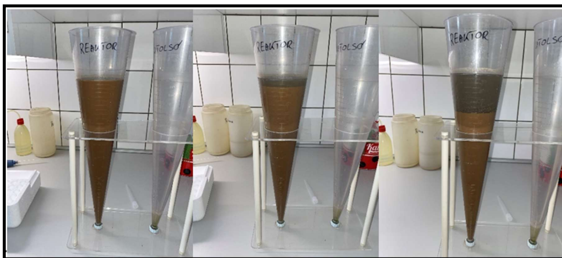
6. ábra Ülepítési vizsgálat (forrás: Heineken Hungária Zrt.)
