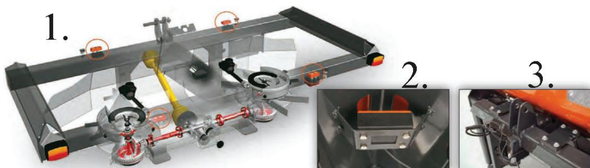
13. ábra Mérőcellák a műtrágyaszórón 1. 4 db 5 tonna mérőcella, 2. 1 db referencia szenzor, 3. 1 db 10 tonna mérőcella
