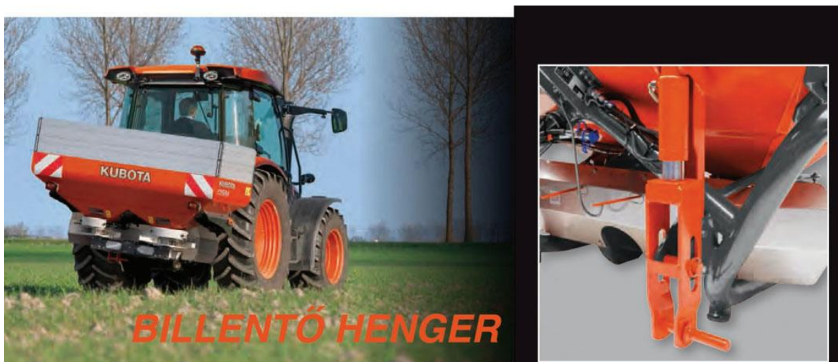
15. ábra Billenő henger munka közben
