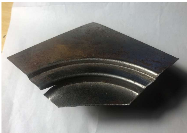
16. ábra Próbagyártás során elszakadt lemezalkatrész
