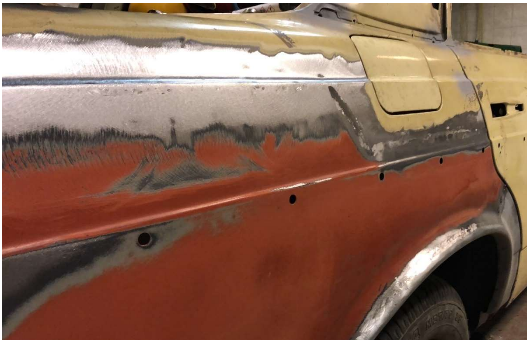
28. ábra A leköszörült illetve részben lecsiszolt felület
