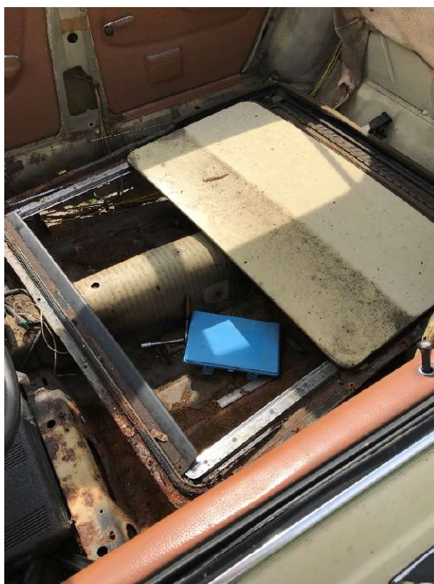
11. ábra A leszerelt napfénytető részegysége
