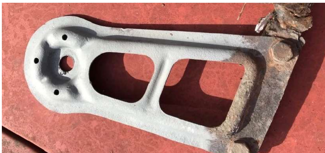
10. ábra Szemcseszórással részben megtisztított bölcső bekötési pont merevítő
