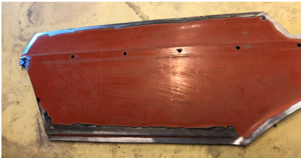
25. ábra A kivágott, körbetisztított elem hátsó része
