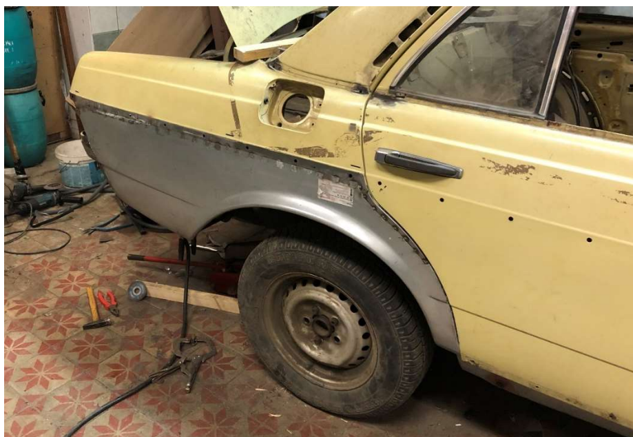
23. ábra A helyére illesztett javítóelem
