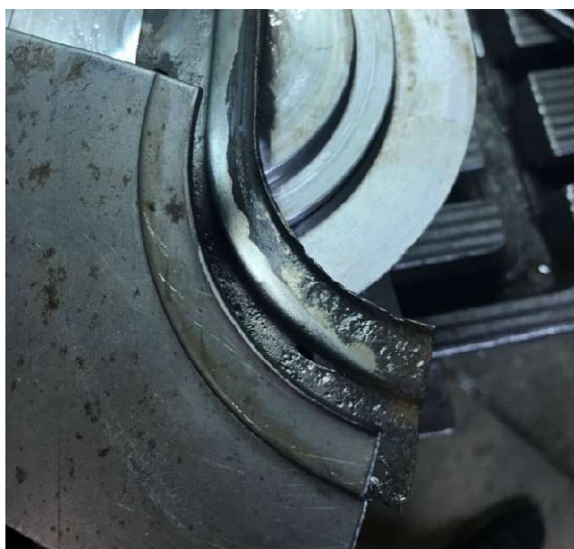
18. ábra Az elkészített javítódarab és az eredeti rész összehasonlítása
