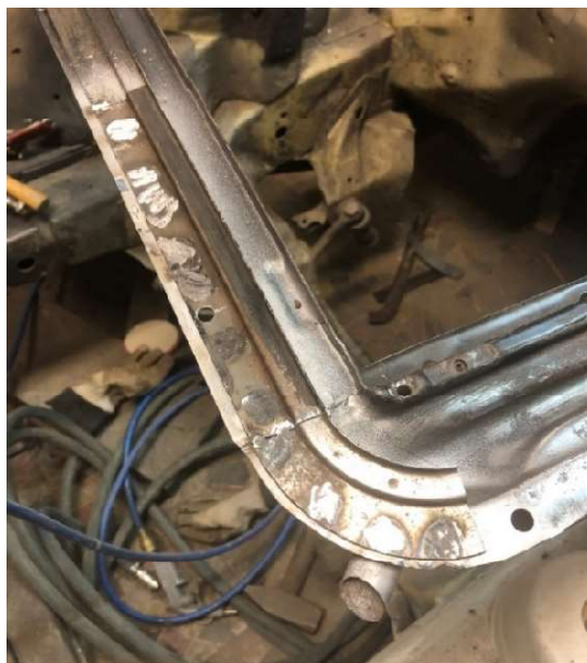
19. ábra A helyükre illesztett javítódarabok
