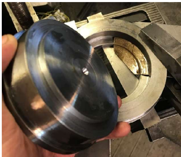
17. ábra A húzóbélyeg, háttérben a kisajtott alkatrészek a húzógyűrű és alsó fél közé szorítva
