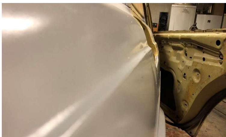
30. ábra A hegesztésnél bevitt hő miatt deformálódott lemez
