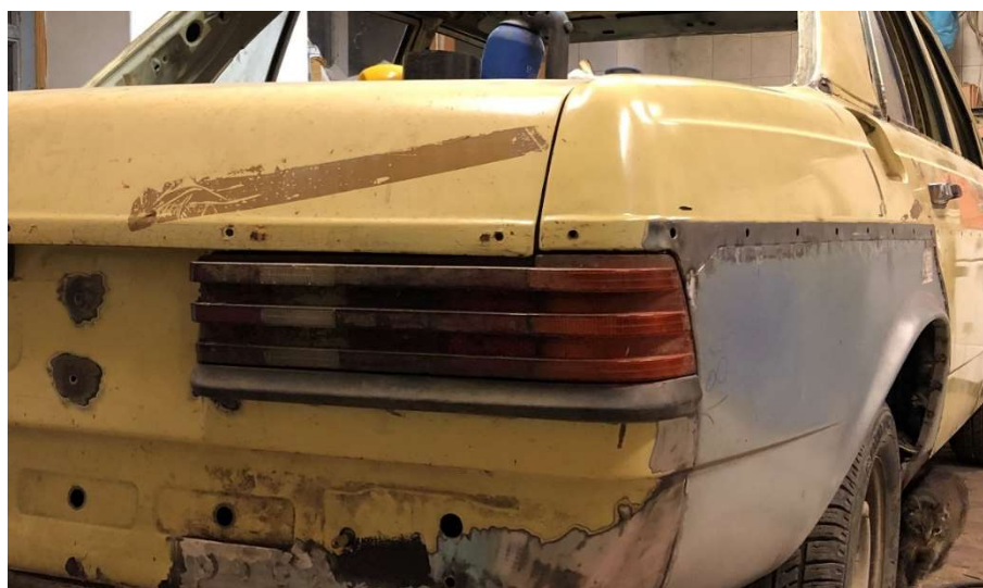
24. ábra A helyére illesztett hátsó lámpa, illetve az alatta levő díszléc felszerelve
