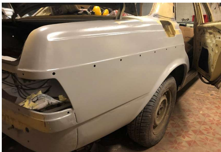
29. ábra Javitott rész felületkezelés után
