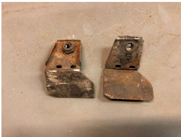
21. ábra Tetőablak magasságának állítását lehetővé tévő alkatrészek
