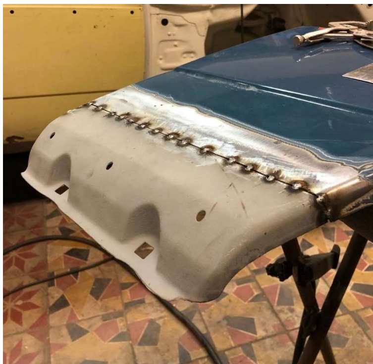
22. ábra Sárvédő alsó javítóelemének felhelyezése
