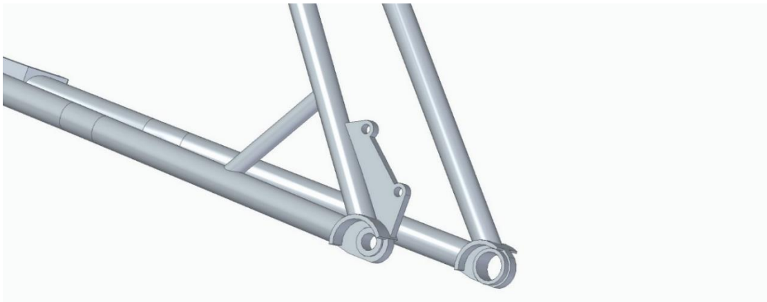
10. ábra IS fékfelfogatás kialakítása (forrás: saját szerkesztés)
