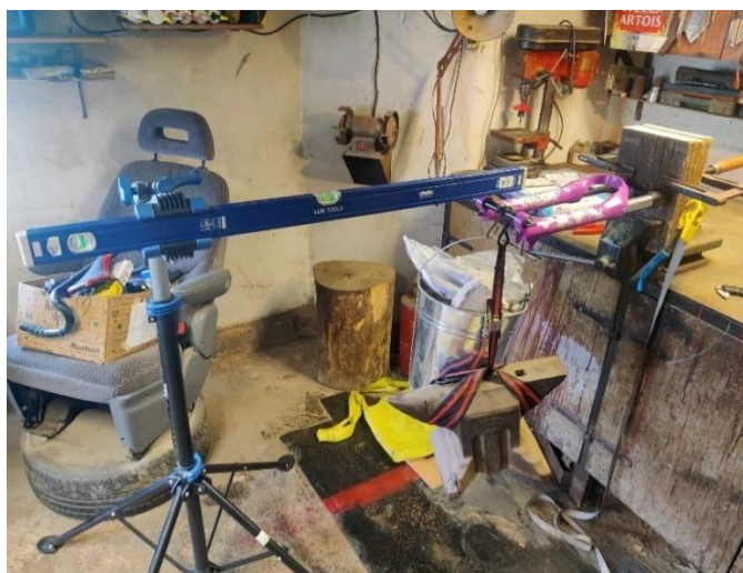
30. ábra Teleszkóp merőleges rugalmasságának mérése (forrás: saját szerkesztés)
