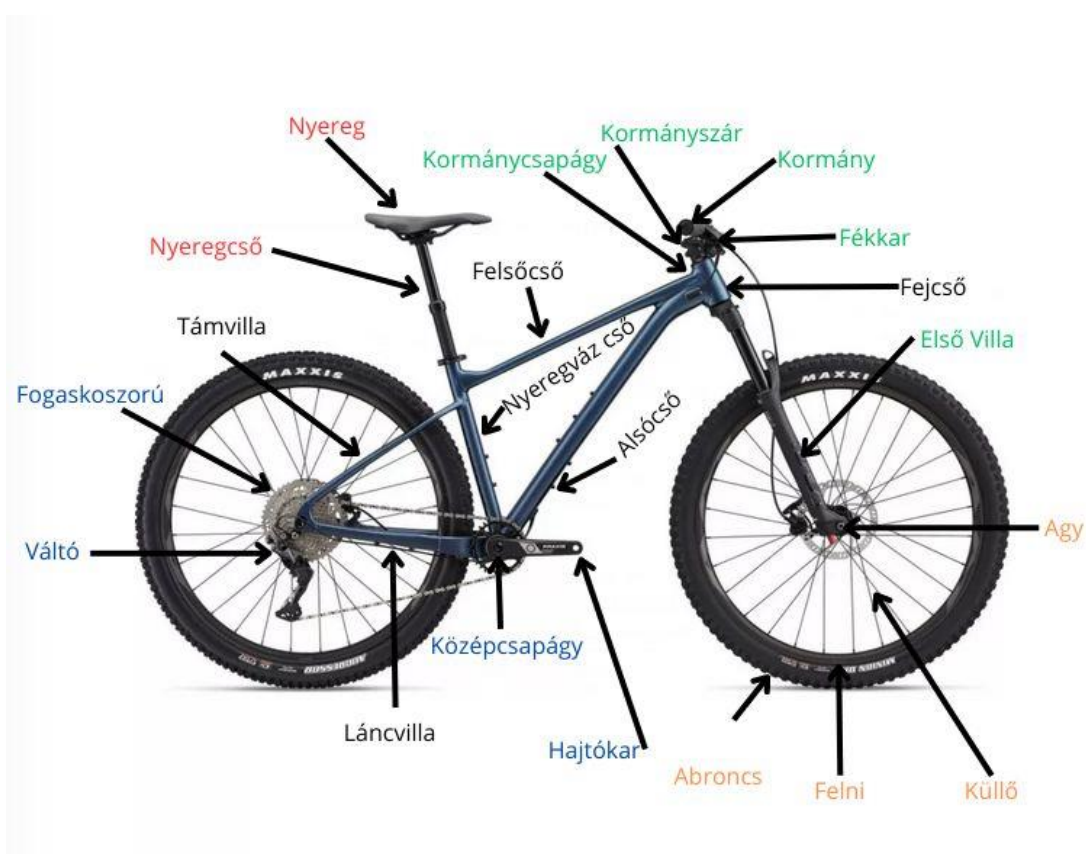
3. ábra Kerékpár felépítése (forrás: saját szerkesztés)
