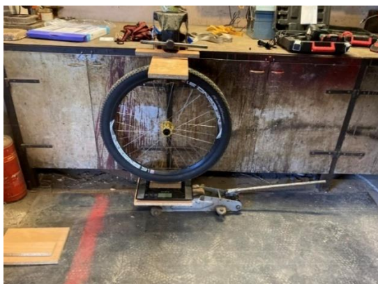
34. ábra Gumiabroncs rugalmasságának vizsgálata (forrás: saját szerkesztés)
