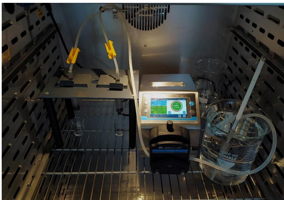
8. ábra Kis méretű oszlopos kísérlet inkubátorban végezve (CSFK-FTI, 2023.02.15.)
