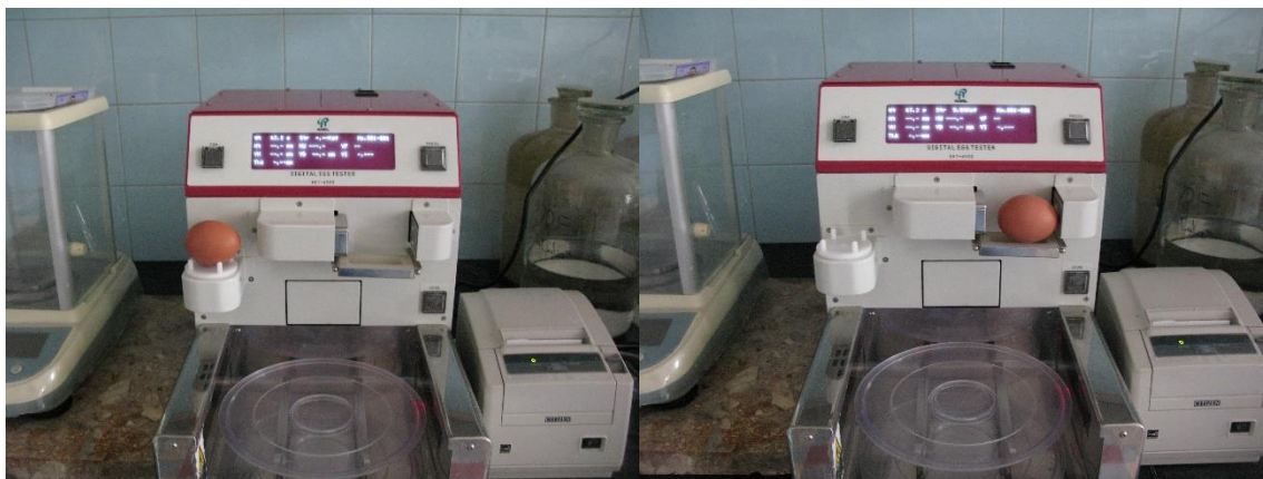
8. Ábra: Tojás súlyának és a héjszilárdságának mérése (forrás: saját)
