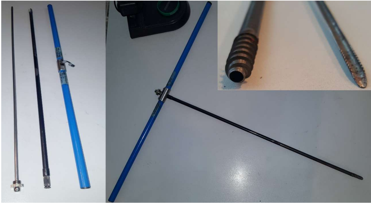
10. ábra. A mintavételhez használt Pressler-féle növedékfűrő. (Bodolay 2023)
