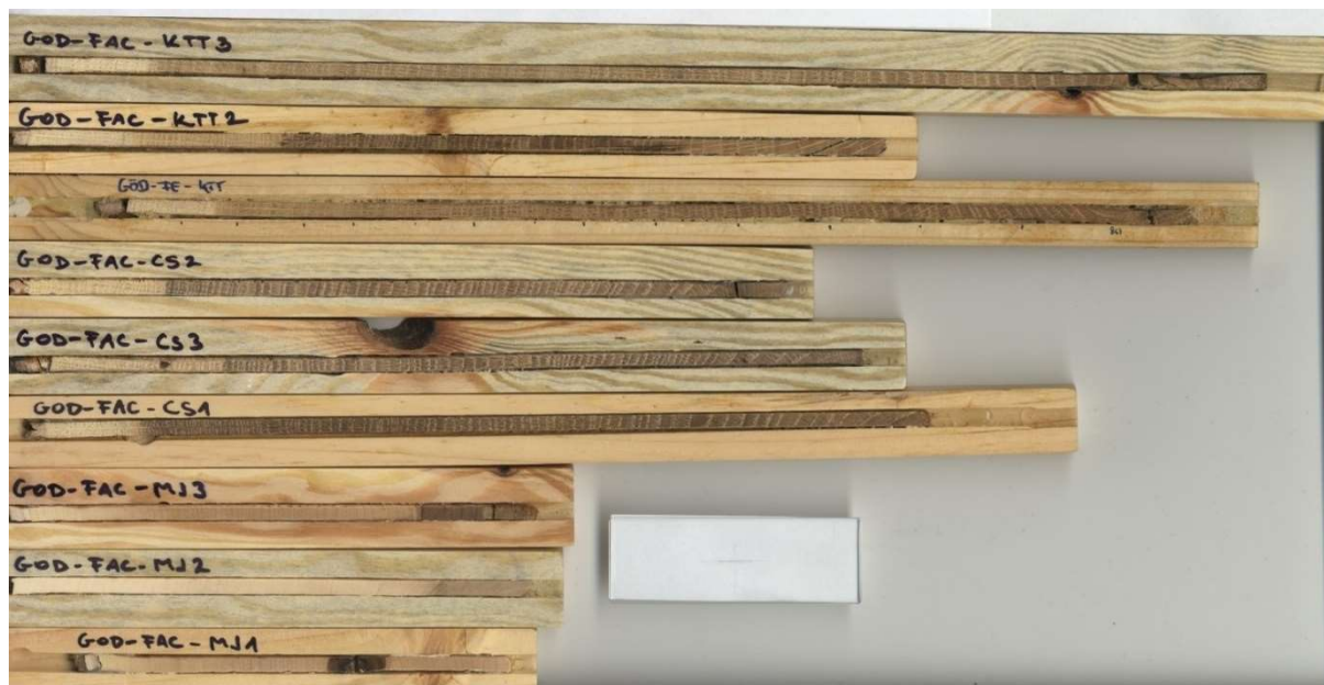
9. ábra. A kutatás során vételezett minták a mintatartó lécekben kódokkal ellátva, mellettük a kalibrációs lemezzel. (Bodolay és Saláta 2023)
