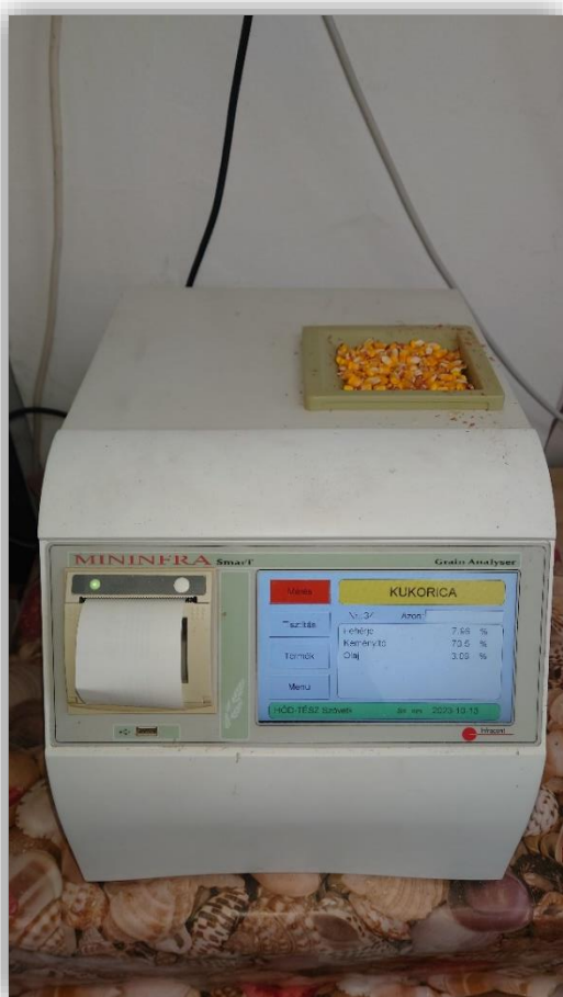
16. ábra: A beltartalom meghatározása Mininfra Smart beltartalom mérővel
