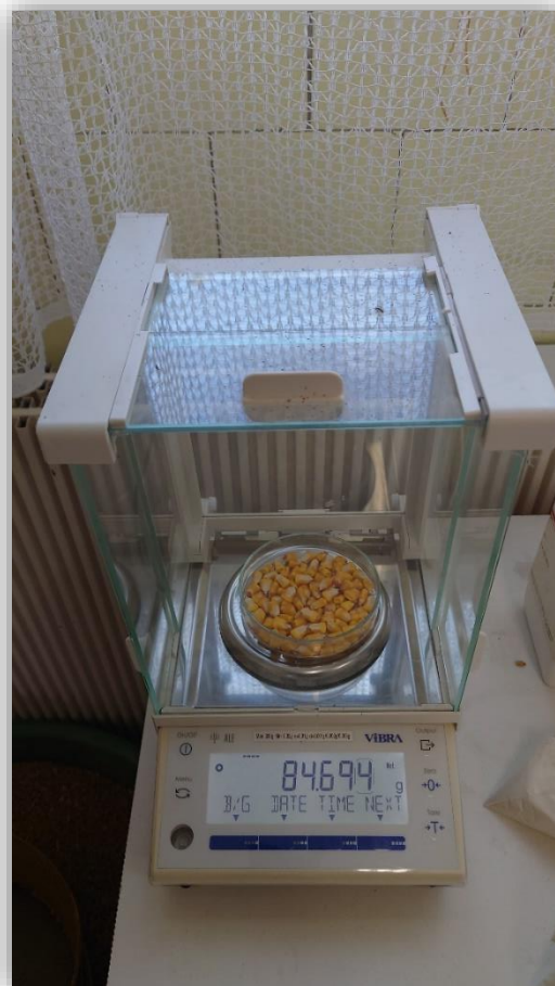
17. ábra: Analitikai mérleggel történő ezermagtömeg mérés
