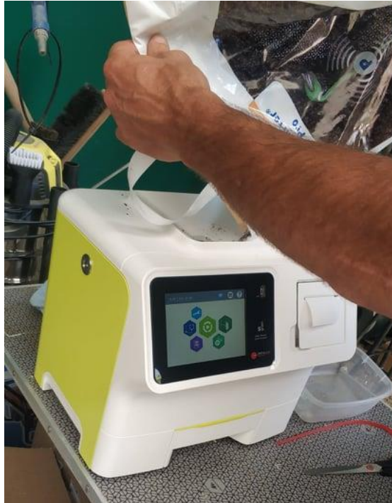
13. ábra: Sgrain Infravörös gabonaelemző műszer (saját fotó, 2022. július 7.)
